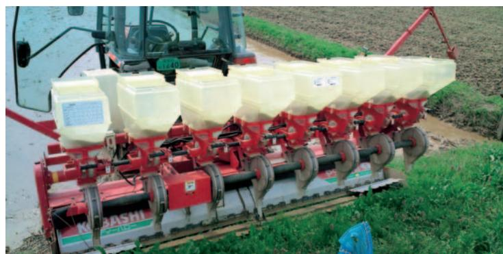
代掻き同時打込み式点播機
