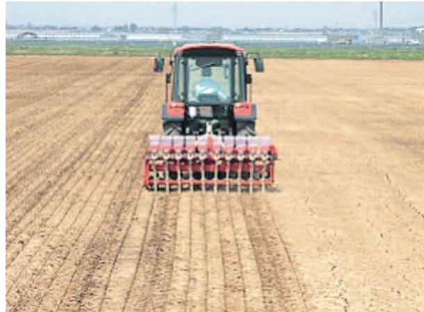
写真1 不耕起V溝直播機による播種作業
