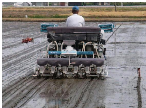
図5 作溝非覆土播種(溝の中に播種し、覆土しない)
