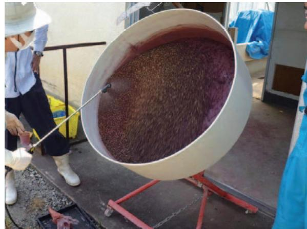
②コーティングマシーンを回して、種子が速く落ちる部分にときどき噴霧器で散水する
