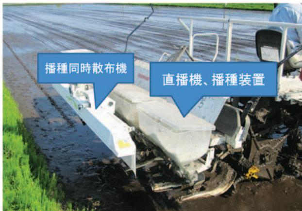
写真 6 播種機と同時散布機（撮影 穴澤）
