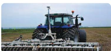
RTK-GNSSレーザーレペラーによるほ場均平作業
